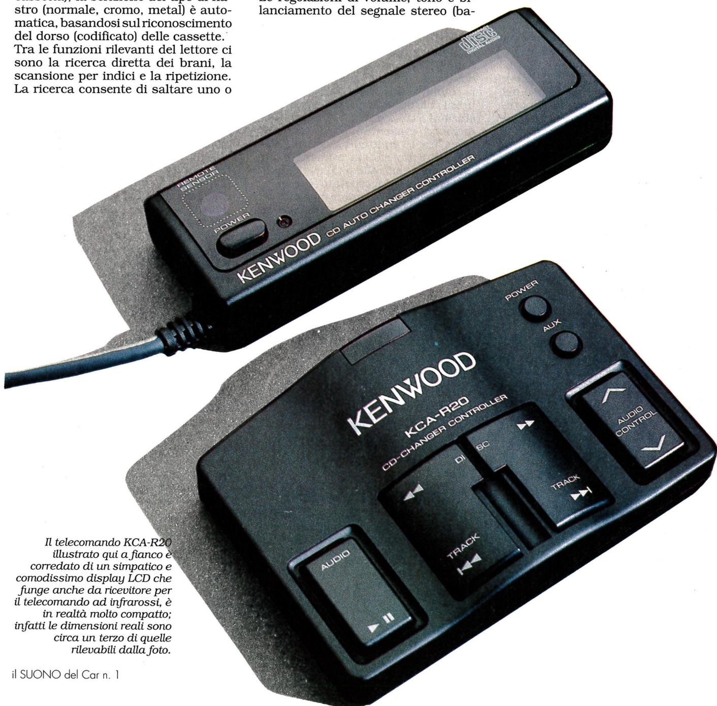
*Il telecomando KCA-R20 illustrato qui a fianco è corredato di un simpatico e comodissimo display LCD che funge anche da ricevitore per il telecomando ad infrarossi, è in realtà molto compatto; infatti le dimensioni reali sono circa un terzo di quelle rilevabili dalla foto.*
